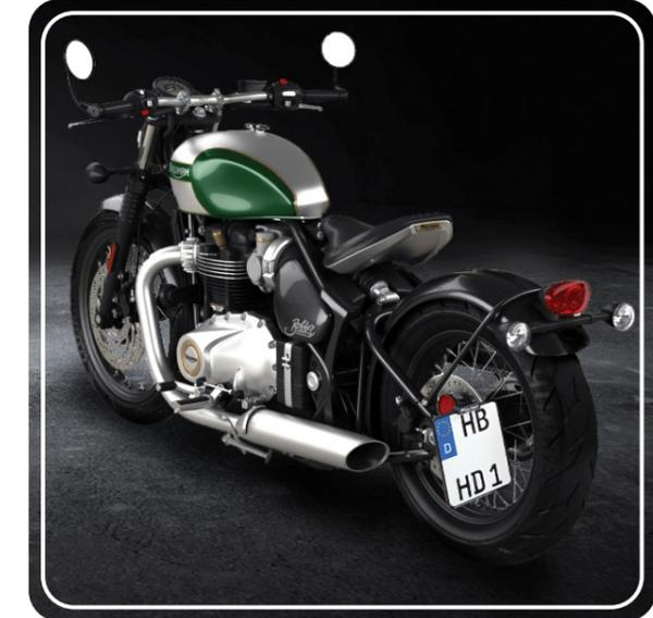
Schraubenlose Montage des Nummernschildes durch einfaches Einschleiben
